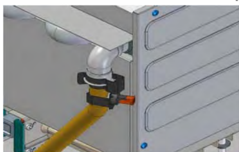
Двойной сенсор отопления (безопасность, регуляция)
